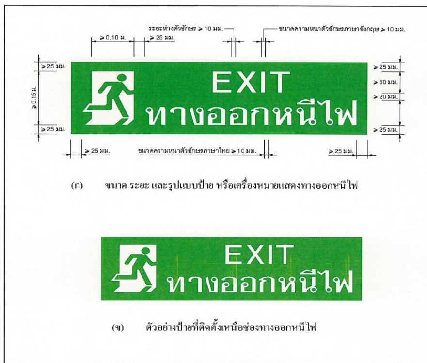
รูปที่ 2.7.8-18 ตัวอย่าง ขนาด ระยะและรูปแบบป้ายหรือเครื่องหมายแสดงทางออกหนีไฟ
